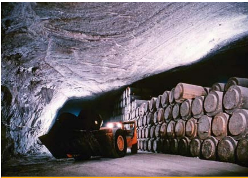
Tiefelader stapeln mit Beton abgeschirmte Atommüllfässer ins Skandal-Versuchsendlager Asse – ein Foto von 1978.
