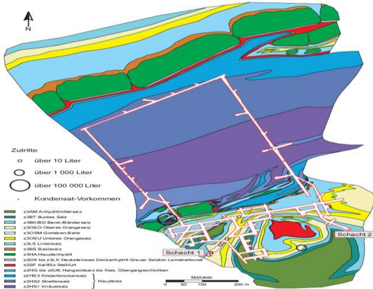
Geologischer Sohlenriß der 840-m-Sohle des Erkundungsbergwerks mit Zutritten über 10 Liter Gesamtzutritt
