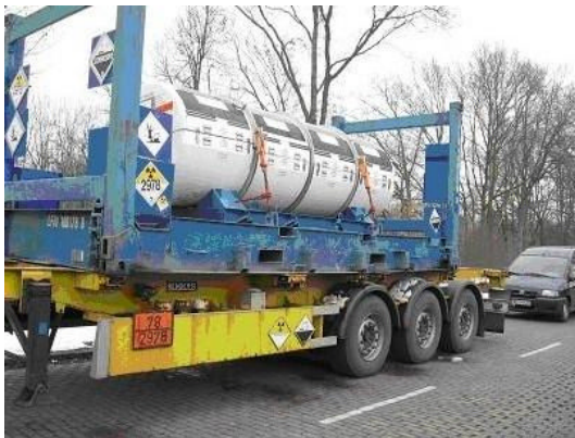
Abbildung 3-1: Durchgerostetes Transportgestell für Uranhexafluorid-Behälter
